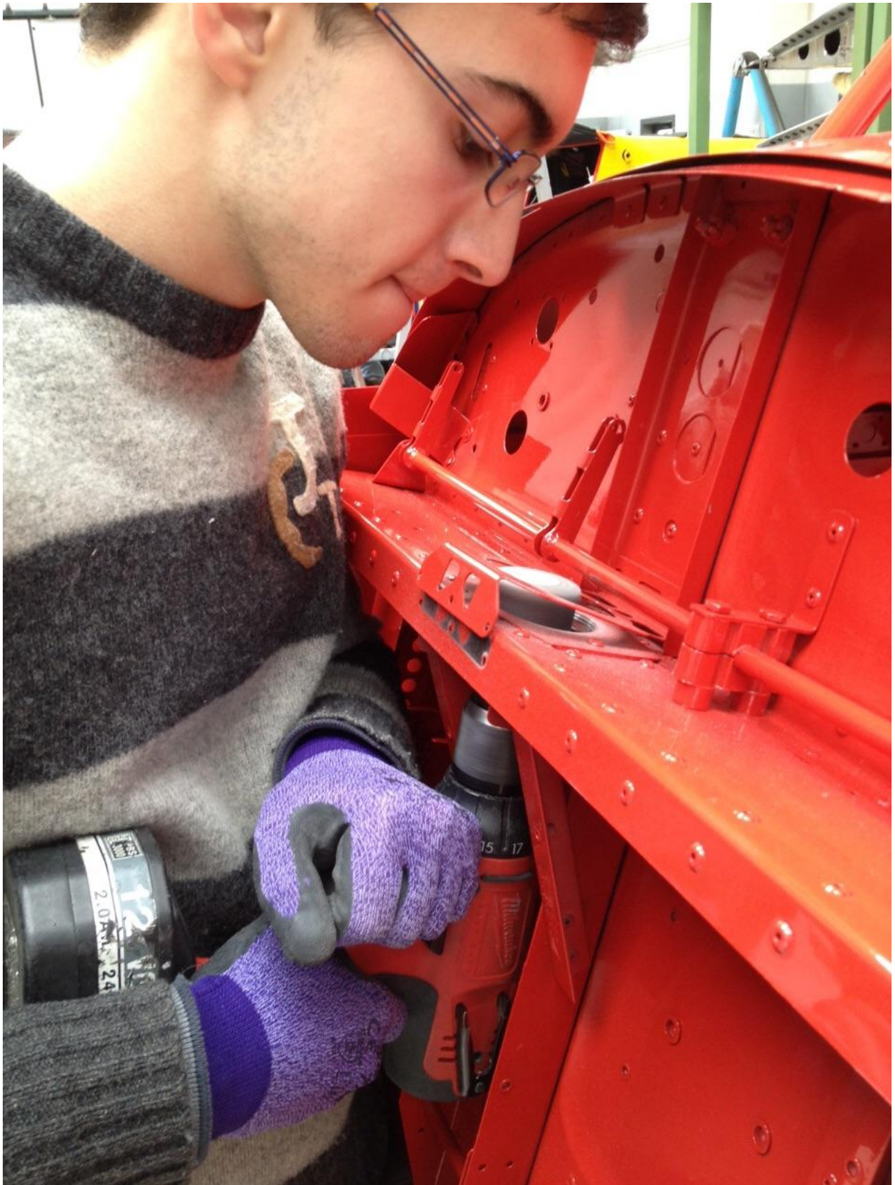
Alessio lavora alla preparazione dell'alloggiamento della gamba del carrello anteriore
