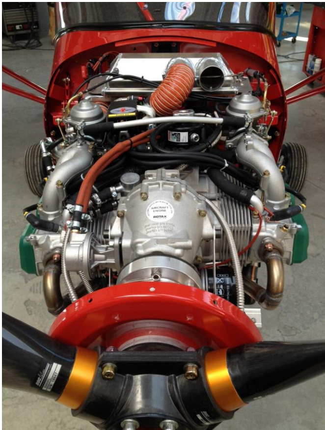
Il motore del Savannah S. Con l'aiuto dei meccanici specializzati si installa sulla struttura di supporto
